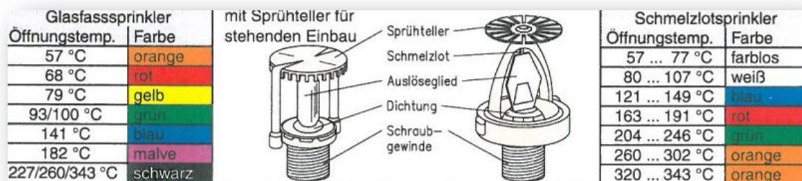
Abbildung 2.2.3.1: Glasfass- und Schmelzlotsprinkler
