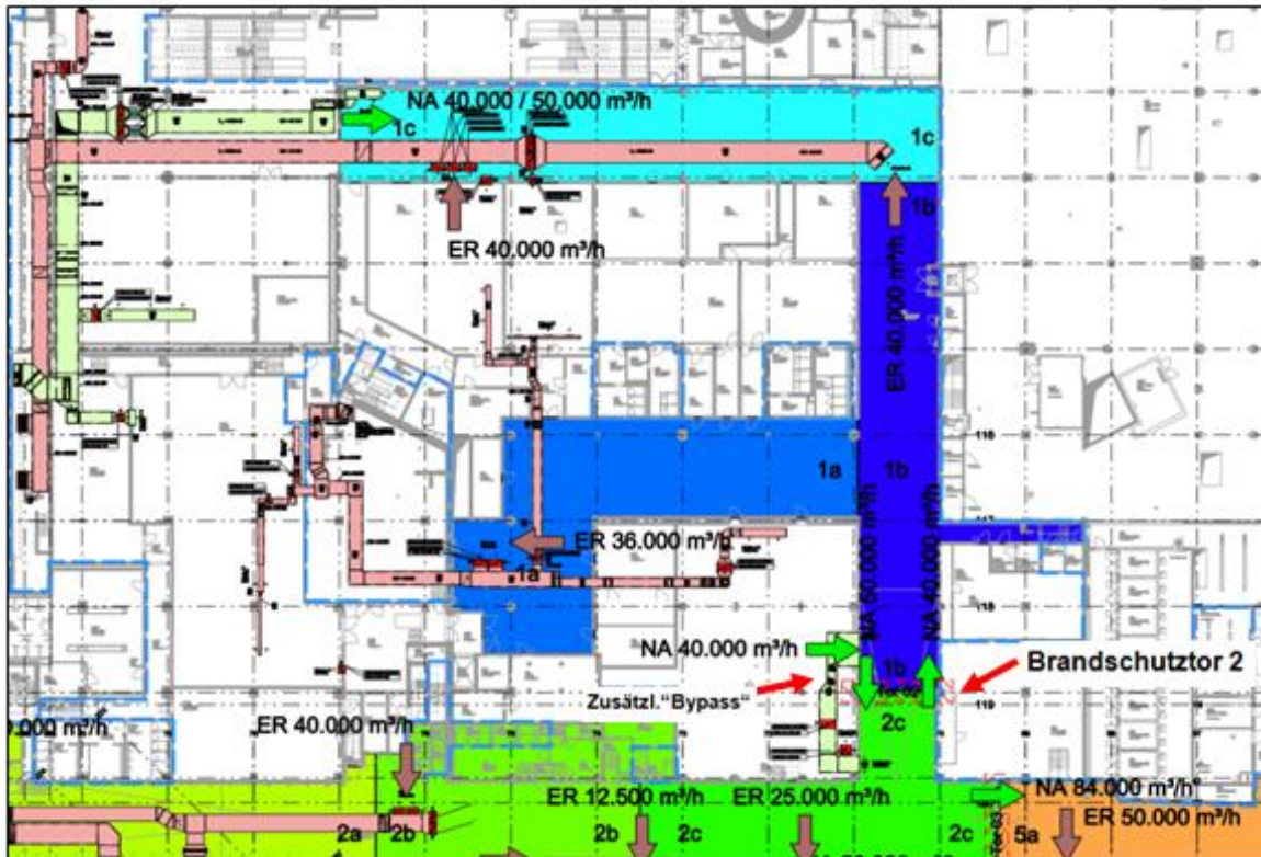
Abbildung 4.1.2: Planung Brandschutzanlagen ERB 1 (Zonen a, b, c)
