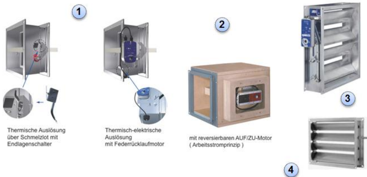
Abbildung 2.2.5-2: Die Absperrvorrichtungen (1-Brandschutzklappe, 2-Entrauchungsklappe, 3-Rauchschutzklappe, 4-Jalousieklappe)
