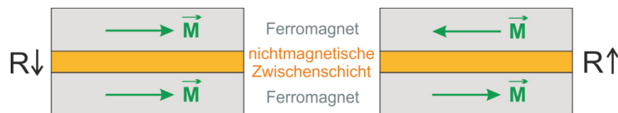
Abb. 2-1: Schematische Erläuterung des Riesenmagnetwiderstandes. Kleinerer Widerstand bei paralleler Ausrichtung der Magnetisierungen (links) als bei antiparalleler Ausrichtung (rechts)
