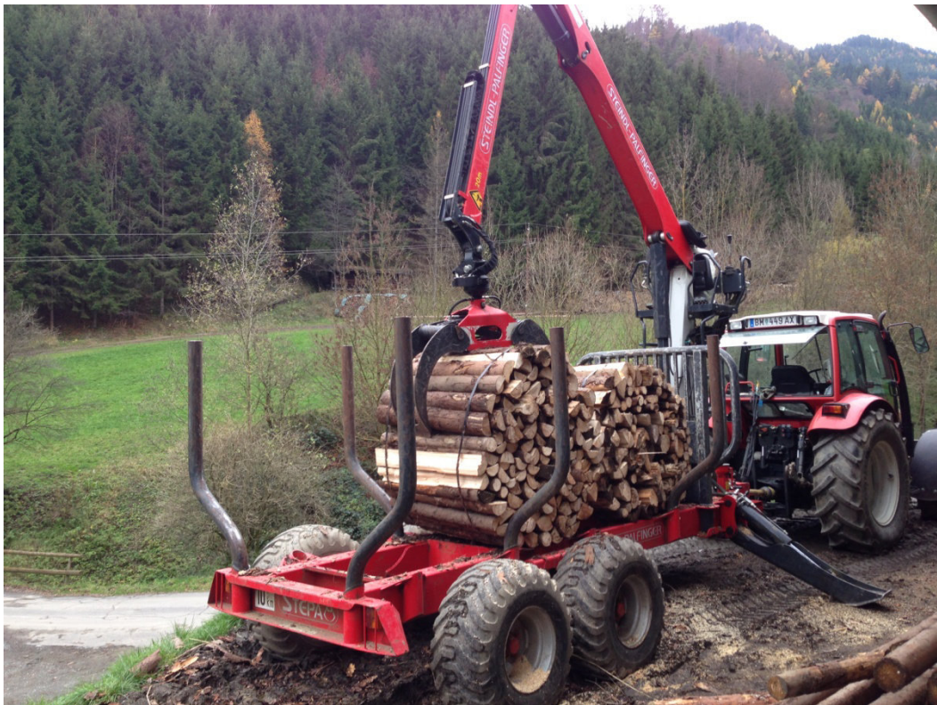
Abbildung 18 Kran zum beladen der Schlitten
