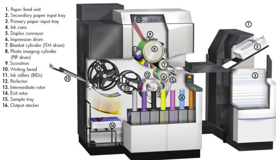
Abb. 7: Digitaldruck mit Elektro-Ink verfahren
