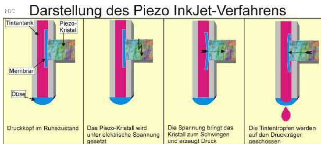
Abb. 6: Darstellung des Piezo Ink-Jet verfahrens
