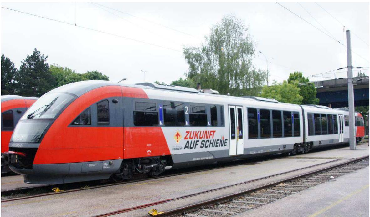
**Abbildung 1** Dieseltriebwagen der ÖBB Baureihe 5022
