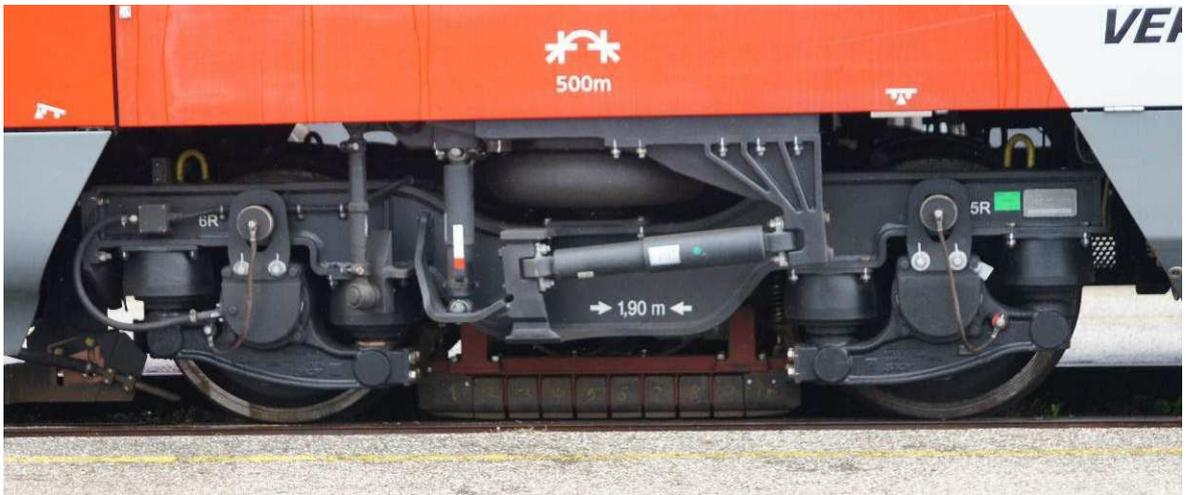
Abbildung 11 Seitenansicht Triebdrehgestell mit Magnetschienenbremse
