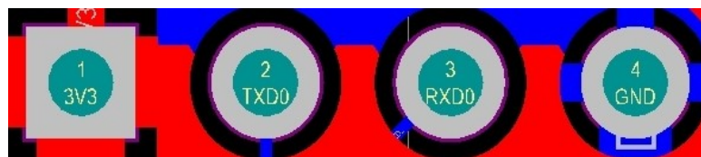
Abbildung 19: Pinbelegung der UART 0
