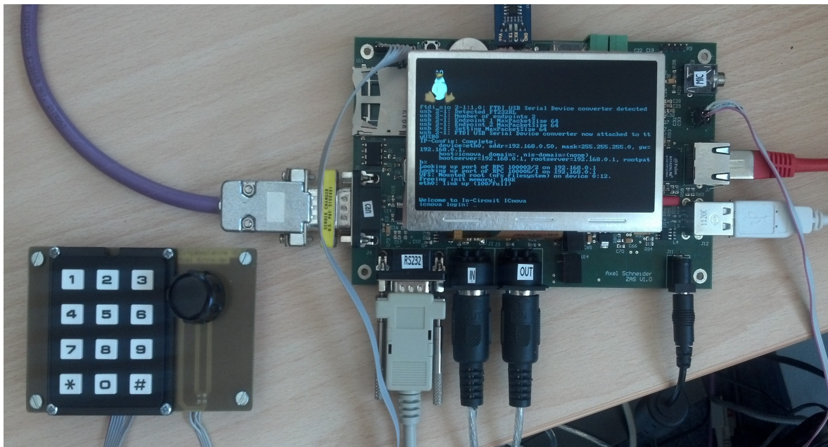
Abbildung 34: Vollständige ZAS mit Bedienschnittstelle bei der Entwicklung der Steuerungssoftware
