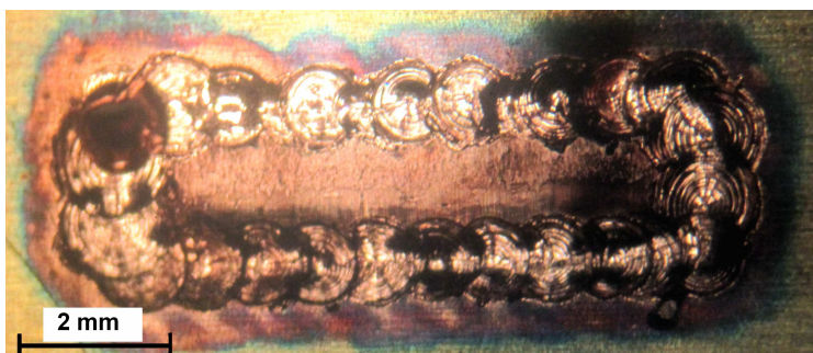
Abbildung 10: Schweißnaht mit Schutzgas [SITEC]
