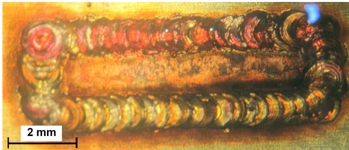
Abbildung 11: Schweißnaht ohne Schutzgas [SITEC]
