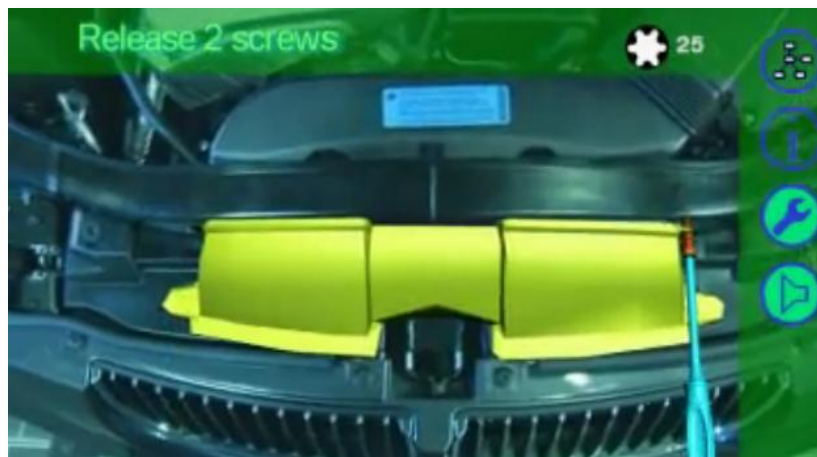
Abbildung 16: Arbeiten im Motorraum eines BMW, angeleitet durch AR. 74
