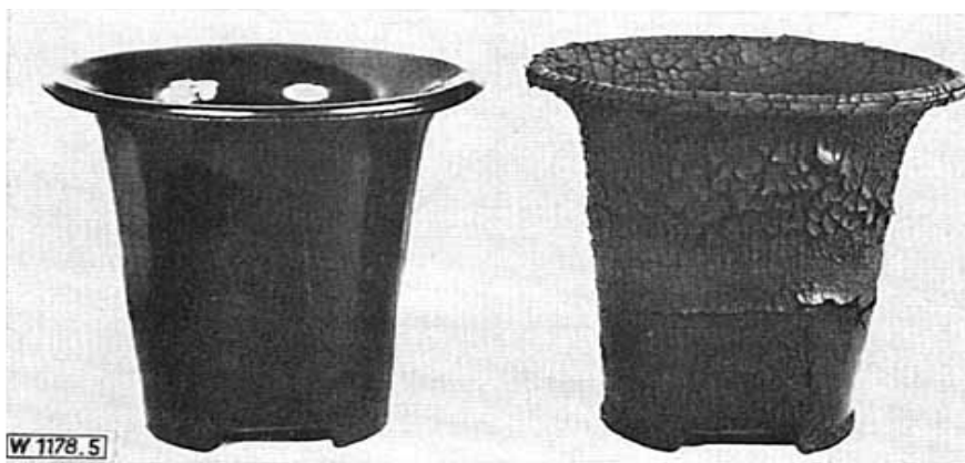
Abbildung 46 Kunststoff -Becher vor und nach dem Kochversuch /78/
