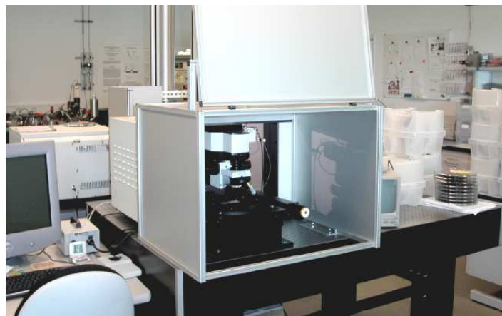
Abbildung 3-4 Versuchsplatz \mu -Raman-Spektroskop
