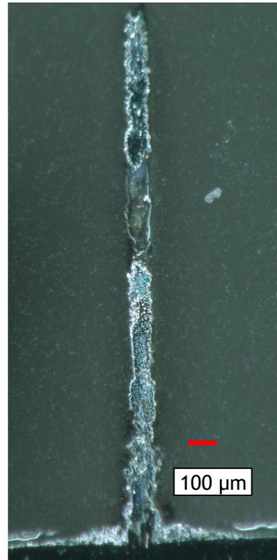
**Abbildung 17** Pyramidenspur mit 500 Wdh. pro Schicht und 25 Schichten, Sockelbreite 103 µm, Breite an der Spitze 57 µm, Höhe 1,82 mm
