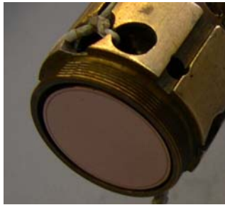
Abbildung 3.12: Die obere Kondensatorplatte in einer Ebene mit dem Zellrand.
