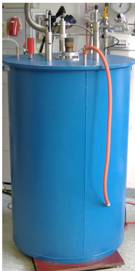
Abbildung 3.2: Kryostat zur Magnetfeldmessung für die Tieftemperaturphysik. Erschütterungen oder sonstige mechanische Vibrationen werden über ein unterliegendes Federsystem kompensiert. Die zylinderförmige Tonne hat eine Höhe von 125 cm und einen Durchmesser von 79 cm. Das wärmeisolierte Gefäß ist mit elektronischen Zuleitungen, Druckanschlüssen, diversen Tanks und einer supraleitenden Spule ausgestattet.
