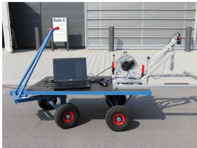
Abbildung 3.1 – Experimentträger mit CCD-Kamera AVT Guppy 080-F
