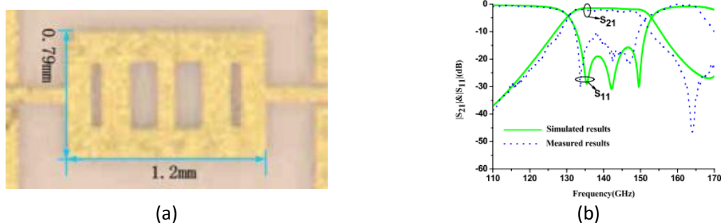
Figure I.12 Filtre SIW en technologie LTCC : (a) photographie et (b) paramètres S, issu de [I.45].
