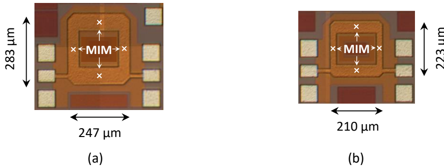
Figure II.33 Photographies des filtres chargés présentant une bande passante de 12% et centrés à 140 GHz. Le paramètre d'adaptation y_{\text{init}} de la synthèse vaut 20 dB pour (a) et 100 dB pour (b) .
