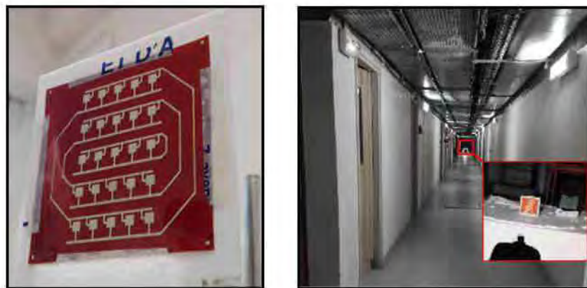
Figure 65. (a) Capteur passif d'humidité Van-Atta fabriqué sur Kapton flexible. (b) Mesures effectuées à longue distance (60m) dans un couloir.
