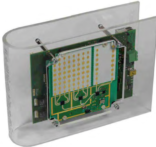
Figure 151. Photographie du radar FM-CW RBK_8 (INRAS GmbH)
