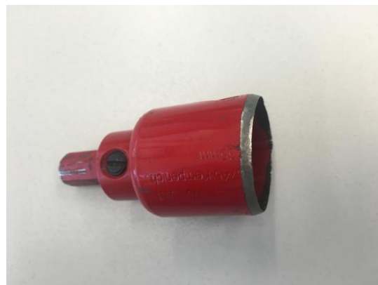
Abbildung 5 Modifizierte Lochsäge zur Fettprobenentnahme
