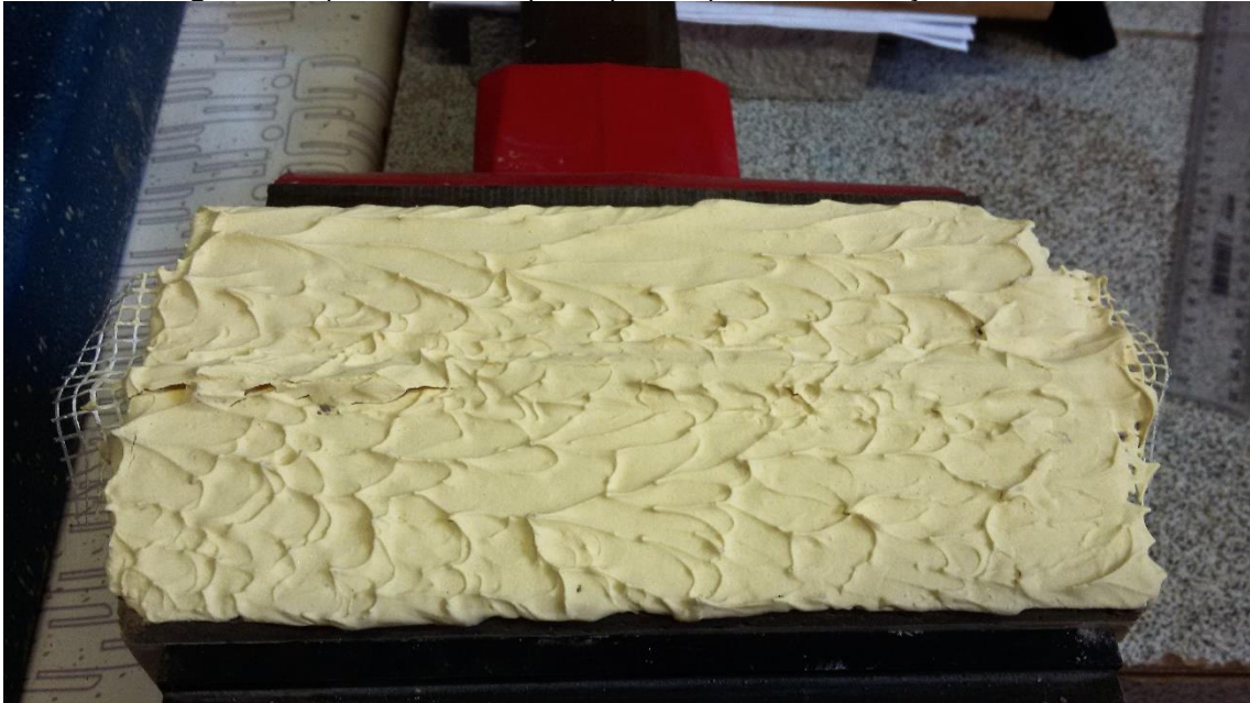
Imagem 7 – Aparência do corpo de prova após movimentação de 5,50mm.
