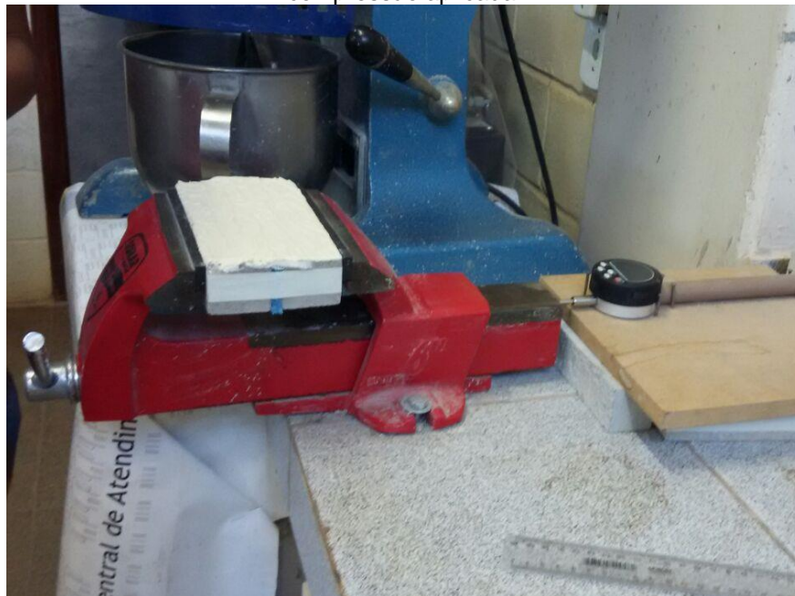
Imagem 6 – Esquema montado para a medição através do dinamometro, da movimentação x compressão aplicada.
