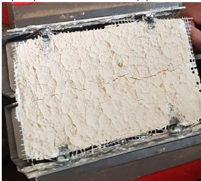
Imagem 16 – Corpo de prova com tela vidro sem Lã, após movimentação de 5,14mm.
