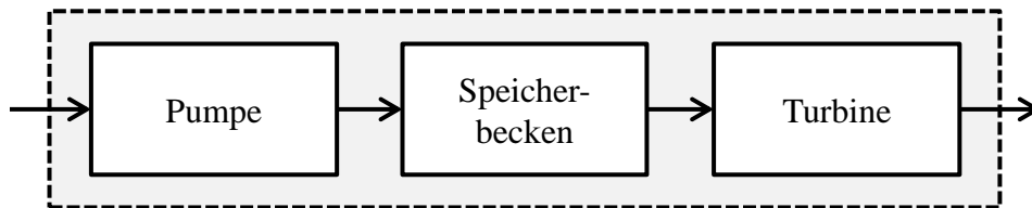
Abb. 4-18: Detaillierte Modellierung eines Pumpspeicherkraftwerkes in TIMES PanEU
