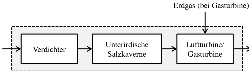
Abb. 4-20: Detaillierte Modellierung eines Druckluftspeicherkraftwerkes in TIMES PanEU
