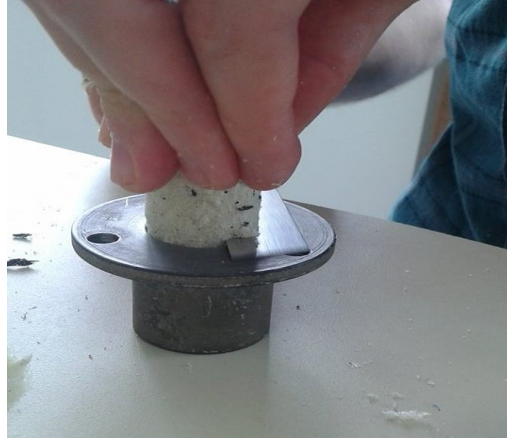
Figura 5 – Porta-amostra com amostra sendo ajustada a espessura com estilete.
