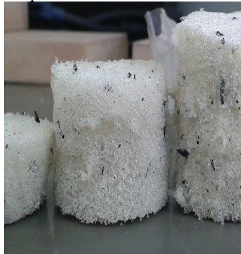
Figura 6 – Corpo de prova com 27 mm de diâmetro e 13 mm de altura.
