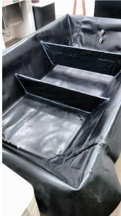
Figura 14 – Protótipo de reator tipo lagoa anaeróbia com duas chicanas verticais.
