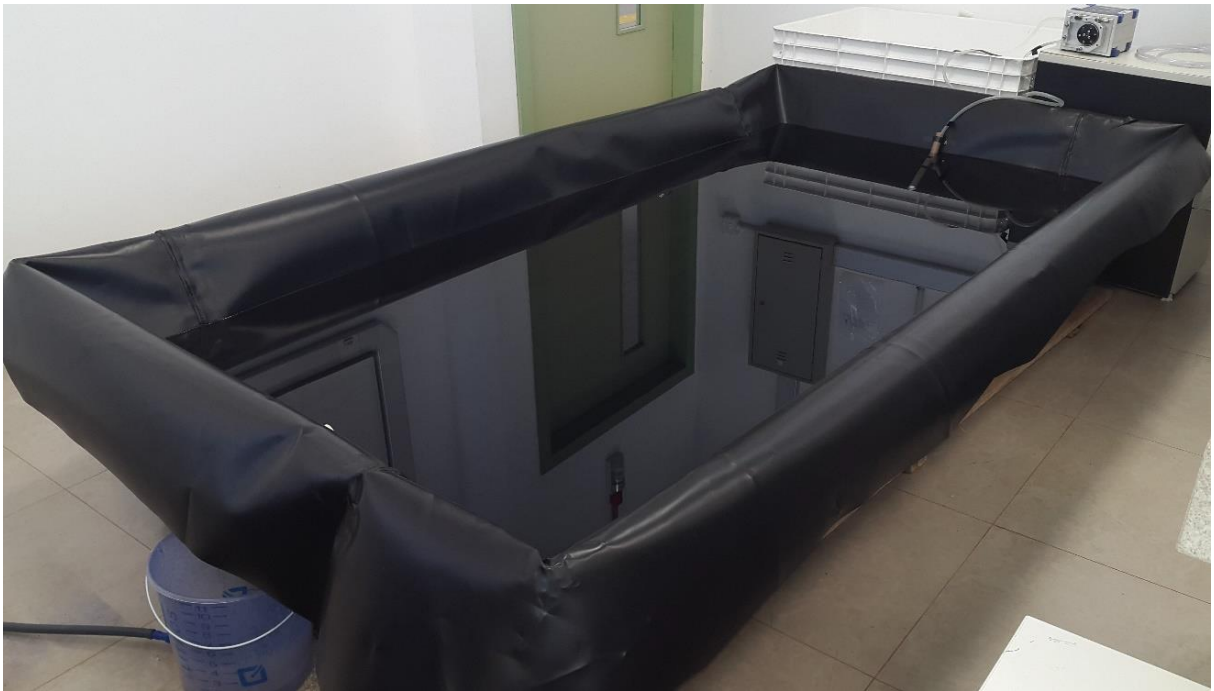
Figura 13 – Protótipo de reator tipo lagoa anaeróbia revestido com geomembrana
