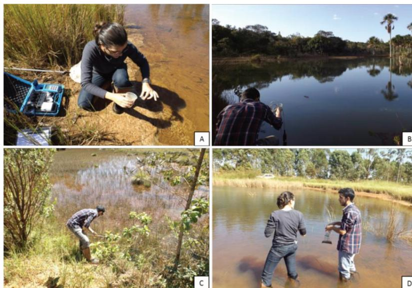
Figura 2 - Medição dos parâmetros físico-químicos, coleta de macroinvertebrados e sedimento nas Lagoas da Fazenda Nova Monte Carmelo: turbidez (A); pH, temperatura e condutividade (B); coleta de macroinvertebrados (C) e; coleta de sedimento (D).
