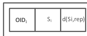
Figura 16 – Representação da estrutura do nó folha completo, onde OID_i é o identificador do elemento, s_i é o próprio elemento, armazenado como um vetor de características e \delta(s_i, rep) é a distância entre s_i e o representante.
