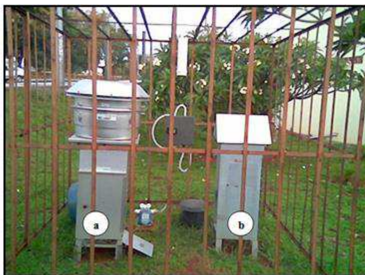
Figura 18 Amostradores de grande volume (a: AGV MP10; b: AGV PTS).
