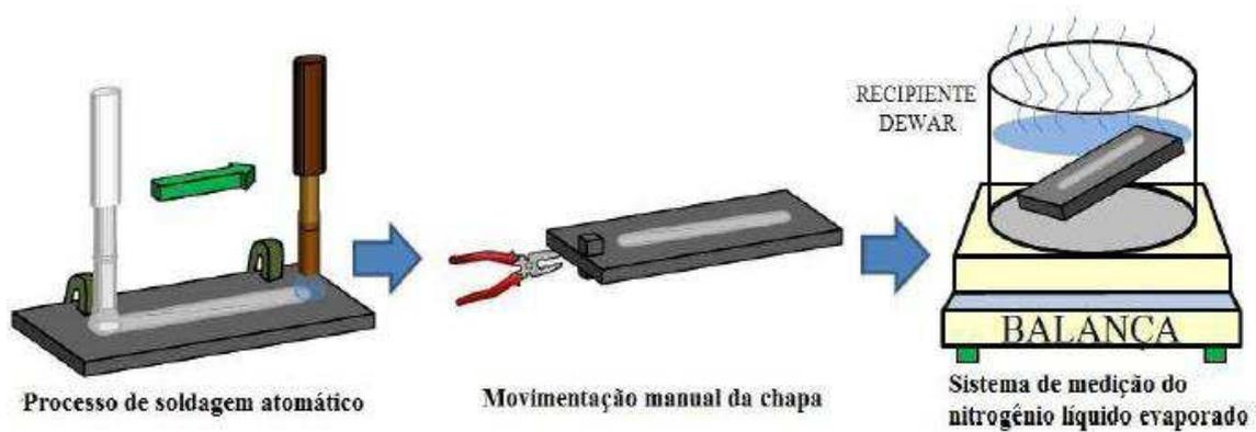
Figura 2.8 – Calorímetro de nitrogênio líquido apresentado por Kenney et al., 1998.
