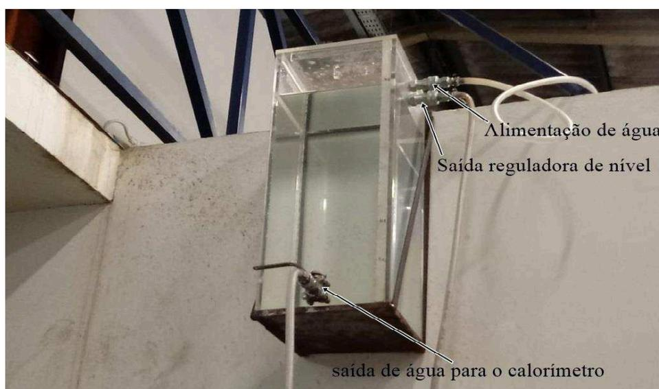
Figura 3.6 – Caixa em acrílico para armazenamento da água utilizada no calorímetro.
