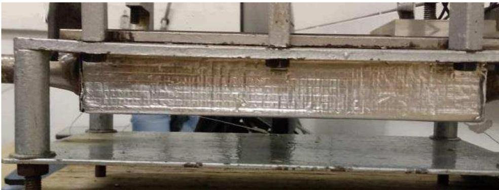
Figura 3.5 – Calorímetro com a manta térmica.
