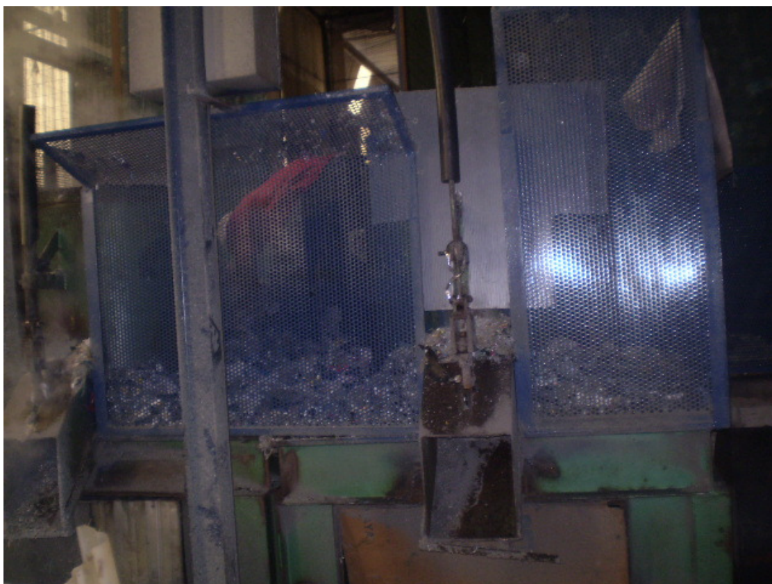
Figura 8: Moinho triturando plásticos para produção do macarrão.
