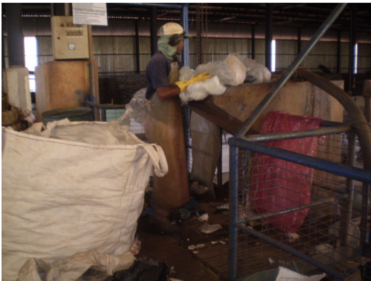
Figura 6: Trabalhador lançando material selecionado para o moinho.
