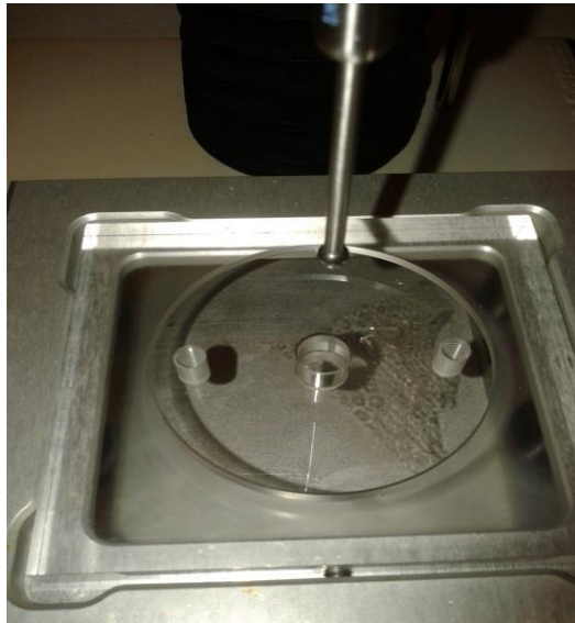
Figura 11 – Representação fotográfica do sistema utilizado para o ensaio de perfuração dos filmes.
