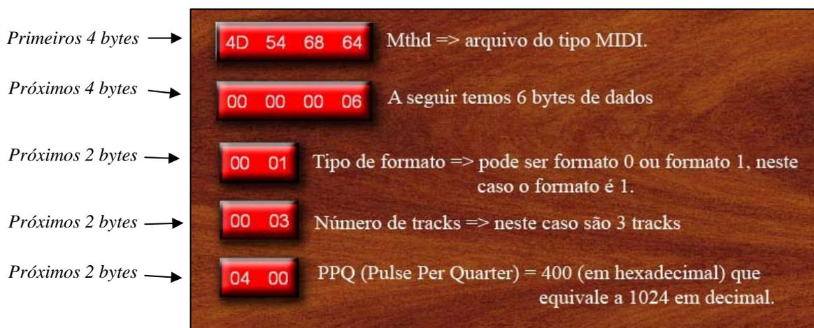
Figura 2.11 – Estrutura do cabeçalho de um SMF em hexadecimal.
