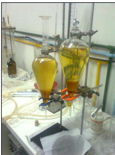
**Figura 10** - Separação por decantação biodiesel e glicerina.
