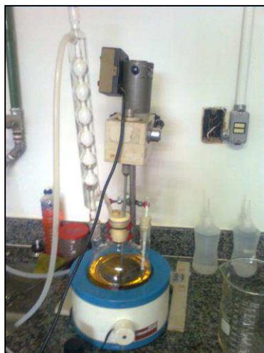
**Figura 9** - Reator utilizado na produção de biodiesel.
