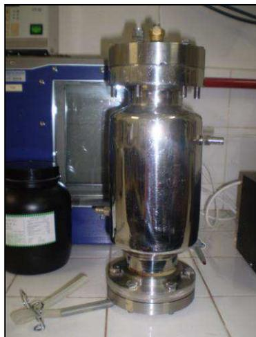
**Figura 11** - Unidade piloto batelada de filtração por membranas.
