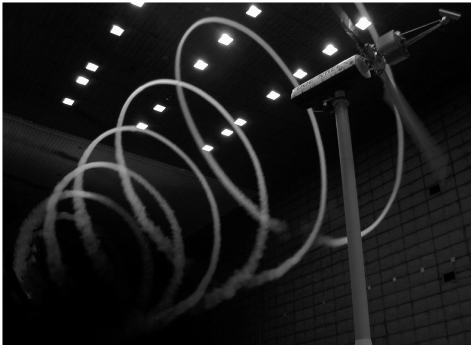
Figura 3 – Teste de um rotor eólico no túnel de vento do Nasa Ames Research Center. Nota-se a modificação no padrão. Retirado de White (2010).
