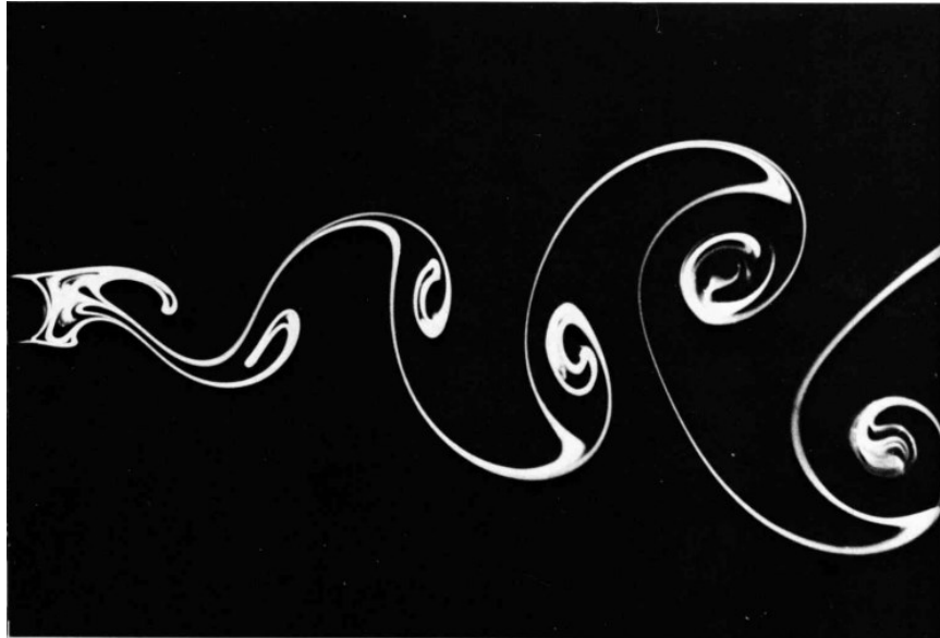
Figura 6 – Esteira de von Kármán atrás de um cilindro circular, com Re=140 . Extraído de Van Dyke (1982).
