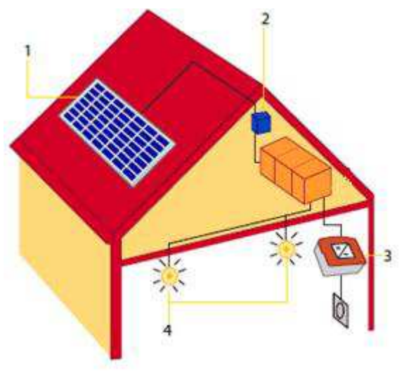
Figura 4 – Sistema autônomo sem armazenamento residencial
