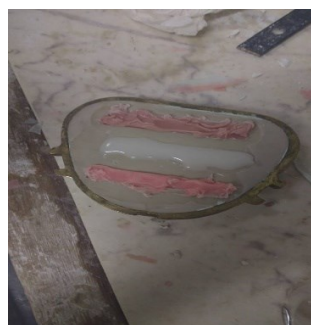
Figura 9. Resinas na fase plástica para prensagem
