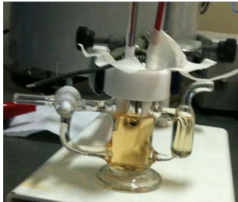
Figura 29: Célula eletroquímica utilizada na medida de voltametria cíclica em solução.
