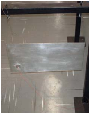
(a) Placa suspensa na condição livre-livre
