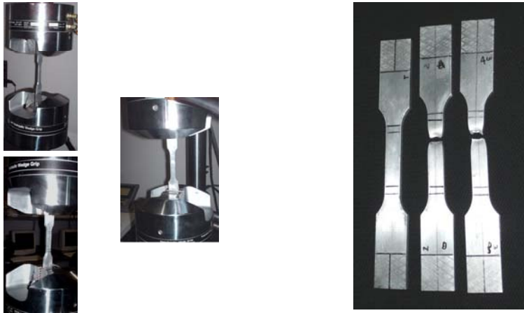
(a) Ensaios de tração (b) Corpos de prova depois do ensaio de tração
