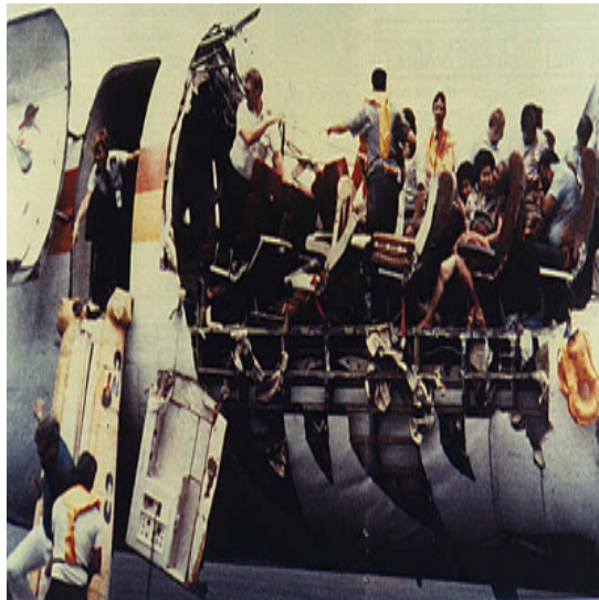
Figura 3.10- Separação da fuselagem do avião da Alhoa Airline em 1988, (FARRAR; LIEVEN; BEMENT, 2005).
