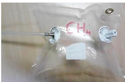
Figura 4.3: Bag de coleta Tedlar com válvula Roberts e união Jacto com septum .
