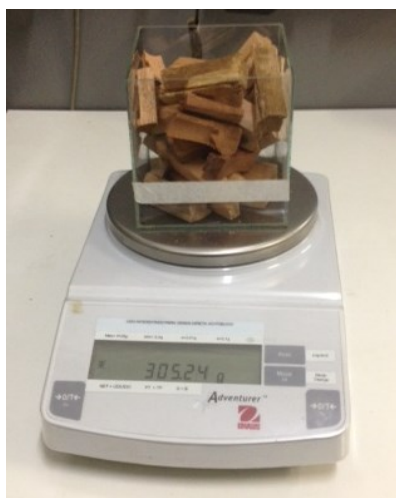
Figura 5.2: lote de amostras pesado em balança de precisão. Fonte: Arquivos do LTCM.
