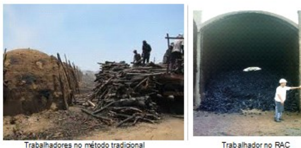
Figura 2.2: comparação entre os métodos tradicionais e com os fornos RAC. Fonte (OLIVEIRA, 2010).
