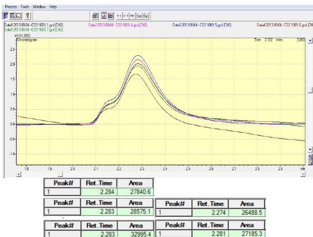
Figura 4.14: cromatograma feito pelo cromatógrafo GC2014 para as cinco injeções de CO 2 no primeiro dia de experimento para uma amostra de 99,9% de concentração. Fonte: (OLIVEIRA, 2014).
