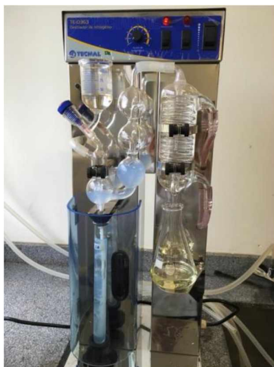
Figura 3.6 - Destilador de compostos nitrogenados propostos Kjeldahl.
