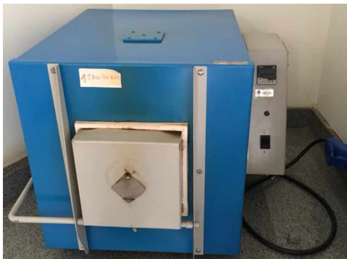
Figura 3.5 - Equipamento mufla para a determinação de cinzas nas biomassas.
