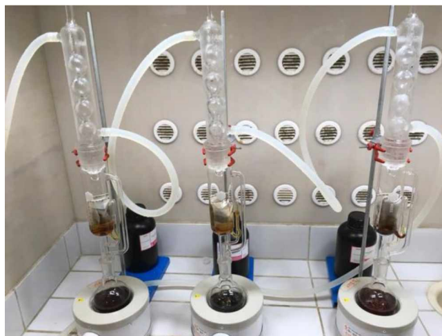
Figura 3.3 - Aparelho de Soxhlet para a extração de gordura.
