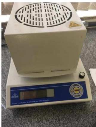
Figura 3.4 - Analisador automático de umidade no infravermelho.
