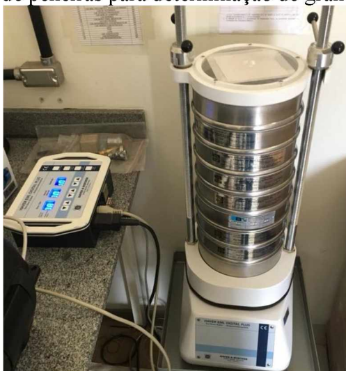
Figura 3.2 - Vibrador de peneiras para determinação de granulometria das amostras.
