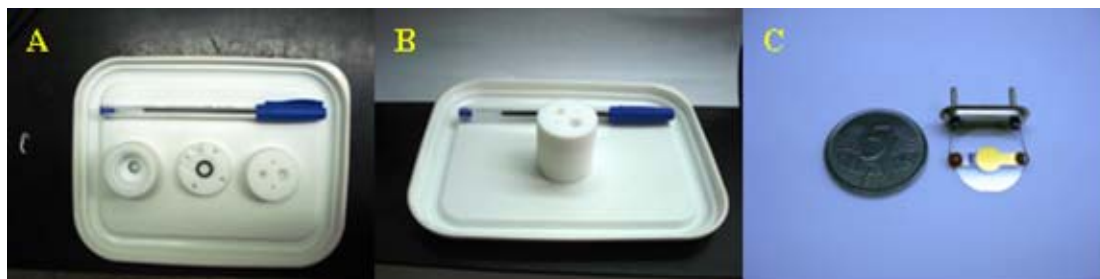
Figura 16: sistema utilizado para a microbalança eletroquímica de cristal de quartzo.
