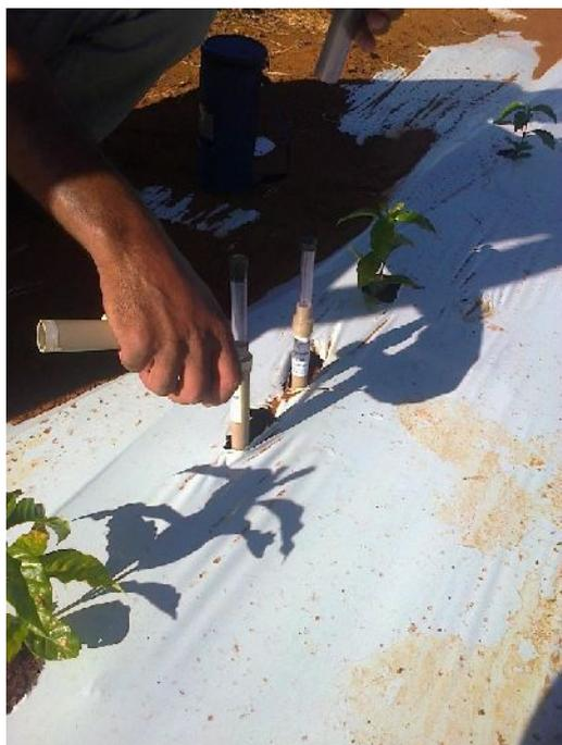
**Figura 3.** Montagem do tensiômetro
