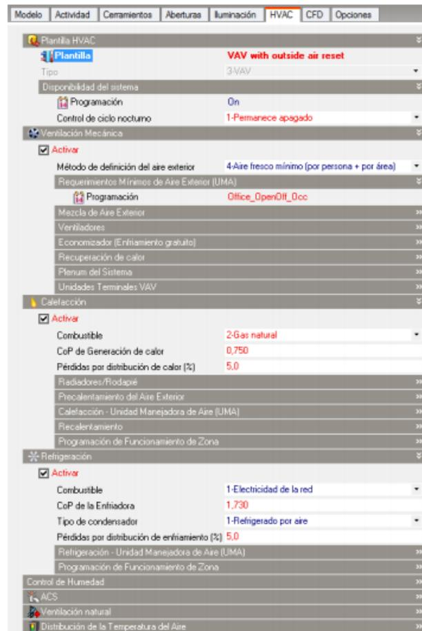
Figura 10.12 Pestaña de entrada de datos de instalaciones térmicas. Elaborado por DesignBuilder, 2018.
