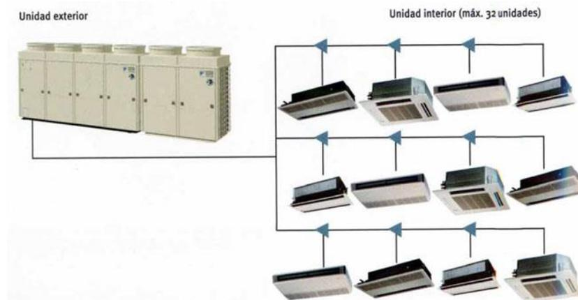
*Figura 8.4* Sistema todo refrigerante. Tomado de Aire acondicionado y climatización (<http://www.aireacondicionadoyclima.com/2013/01/sistemas-de-refrigerante-variable.html>)
