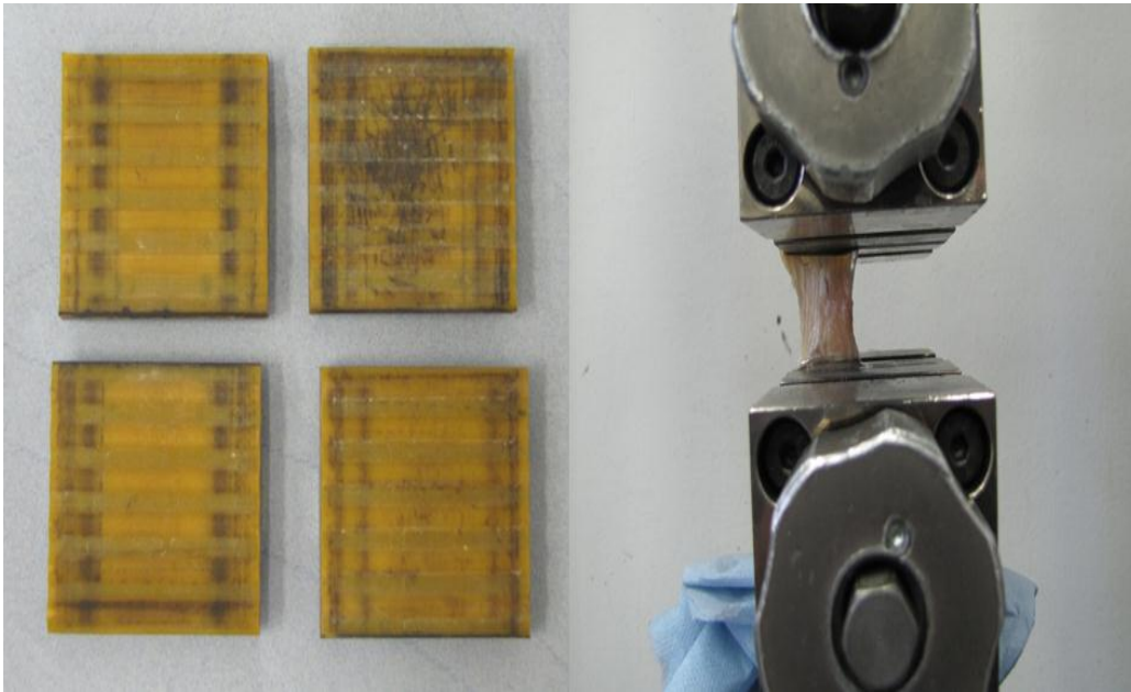
15. ábra: Zwick Z020-as típusú szakítógép általános befogófeje. A kép bal oldalán láthatók a befogófej lapjai.
