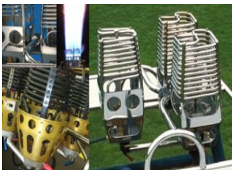
Imagen 2. Sistema carburante (quemador con bastidor de carga y cilindros para el combustible) del globo aerostático anilla.
