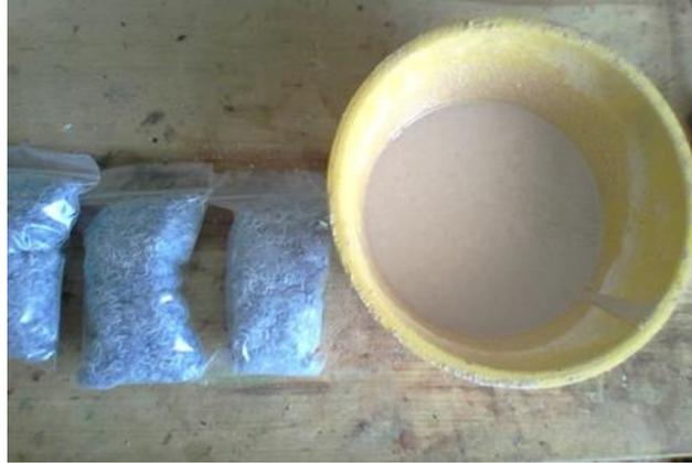
Figura 6.3. Resina polyester/Polvo de mármol/fibras textiles
