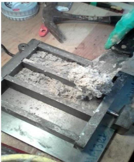
Figura 6.2. Molde para preparación de probetas
