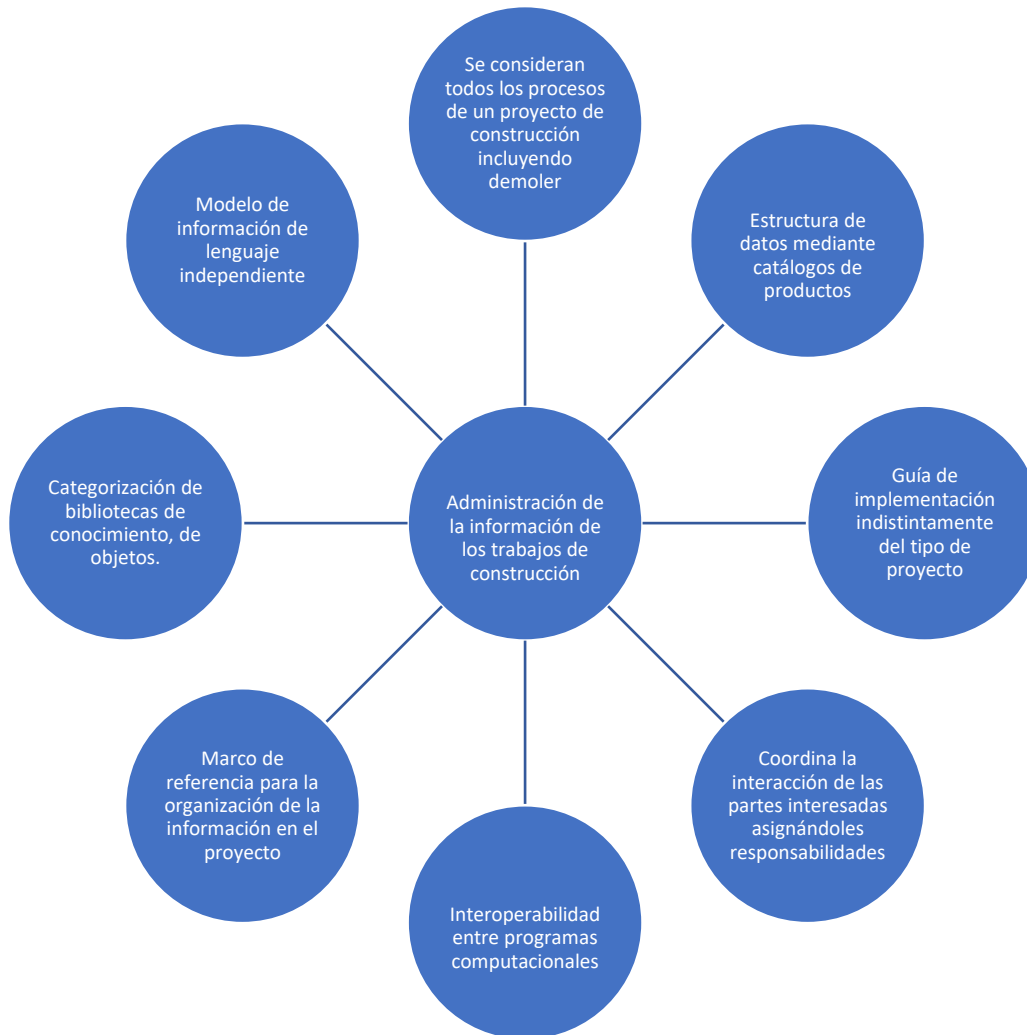
Figura 6. Enfoques de las normas ISO a nivel de modelación de información. Fuente: Elaboración propia con base en International Organization for Standardization (ISO), (2017) y elaboración propia)
