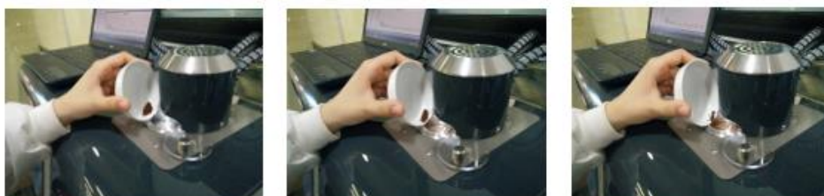
Figura 28. Fases de colocação da amostra de café moído ( 86,0 \pm 0,5 mg) na câmara de admissão do A22 (Fonte: Kaffa, 2017).
