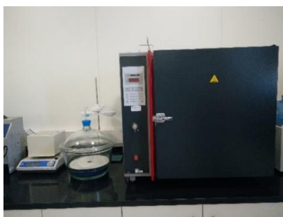
Figura 30. Exsicador e estufa utilizados na determinação da perda de massa por secagem de café torrado moído (Fonte: Kaffa, 2017).
