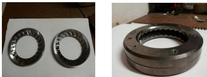
Figura 19. Exemplo de um conjunto de discos constituintes dos moinhos Colombini 250/400 (Fonte: Kaffa, 2017).
