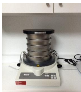
Figura 21. Torre de crivos Analysette 3 Spartan Pluverisette, Fritsch (Fonte: Kaffa, 2017).
