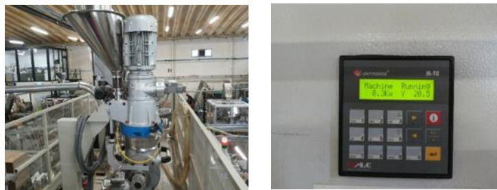
Figura 17. Moinho Colombini (à esquerda) e controlador digital (à direita) (Fonte: Kaffa, 2017).
