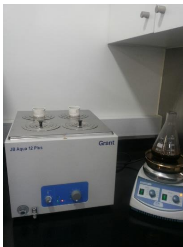
Figura 32. Determinação do extrato aquoso em banho de água (à esquerda) e placa de Aquecimento (à direita) (Fonte: Kaffa, 2017).
