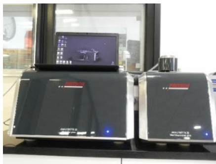
Figura 22. Analisador de partículas por via húmida, Analysette 22 MicroTec Plus Fritsch (Fonte: Kaffa, 2017).
