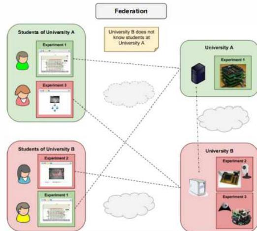
Fig. 2. Esquema de Federación de laboratorios remotos
