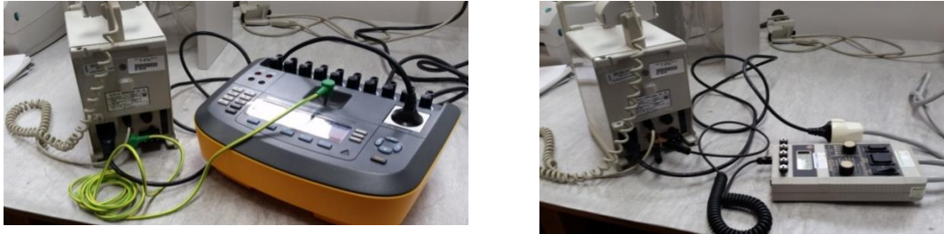
Figura 21 - Testes de segurança elétrica utilizando um instrumento de referência.
