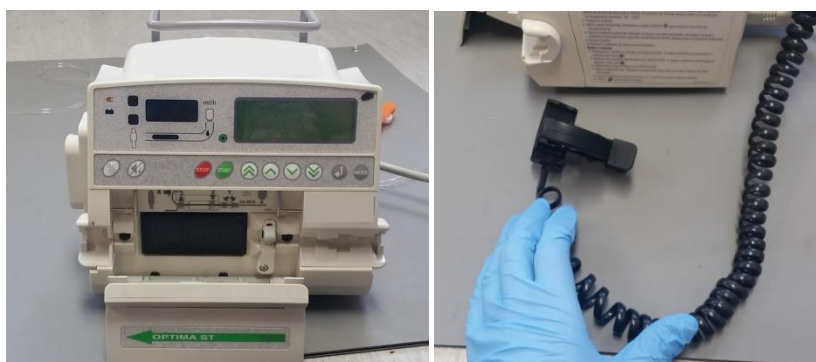
Figura 19: Inspeção visual de uma bomba de perfusão volumétrica: verificação da porta externa e interna (à esquerda) e verificação do cabo do sensor de gotas (à direita).
