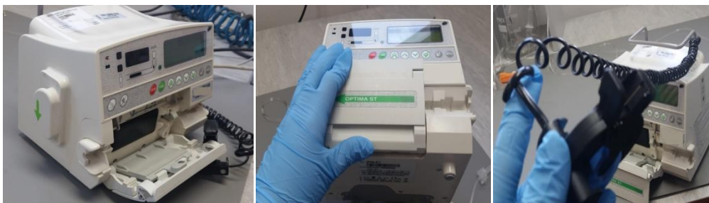
Figura 18: Inspeção visual de uma bomba de perfusão volumétrica: verificação lateral (à esquerda); frontal (ao centro) e verificação do sensor de gotas (à direita).
