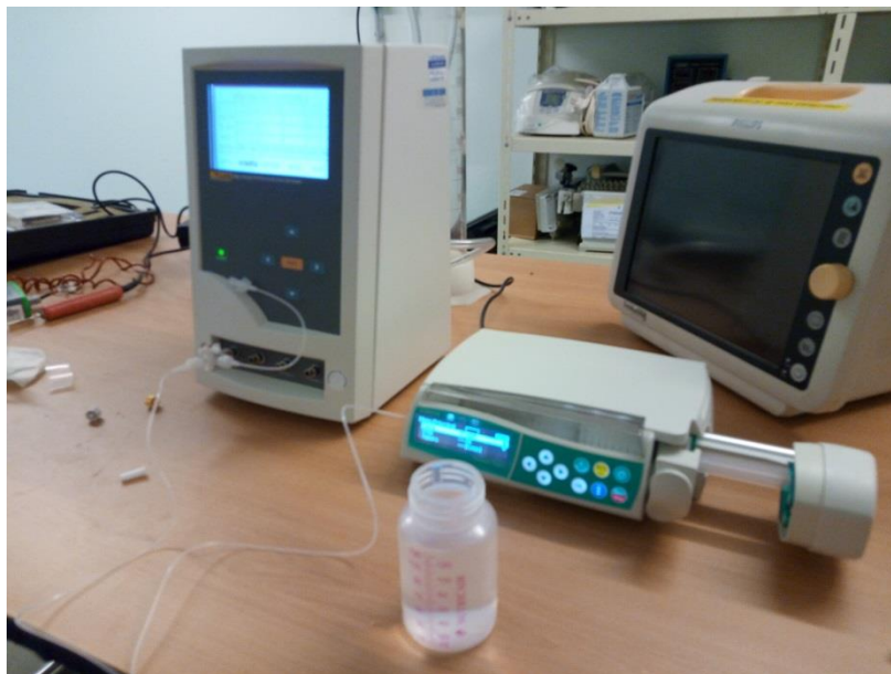
Figura 16: Calibração de uma bomba volumétrica pelo método comparativo.
