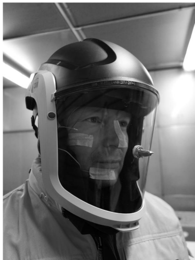
Kuva 3. Iholämpötila-anturit kasvoilla ja ilmanlämpötila-anturi suojaimen sisällä.
