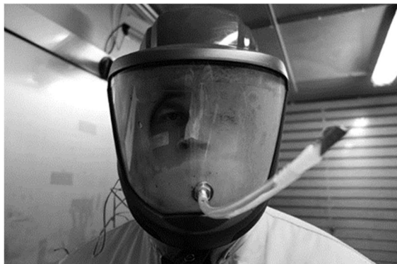
Kuva 1. Kasvonsuojuksen visiirin huurtuminen -20°C lämpötilassa puhallinsuojainta käytettäessä (Rissanen ja Rintamäki 2016).
