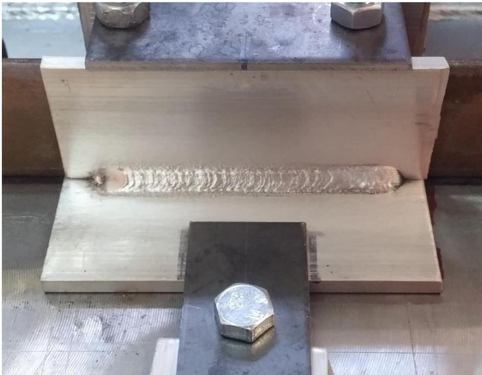
Figura 3.12: Teste feito em junta de canto.
