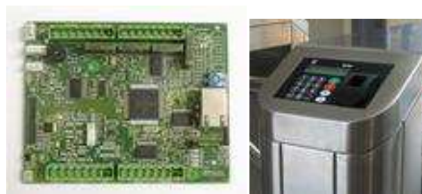
Figura 5.3 Dispositivo BIOMAX2 circuito y integrado en torno.
