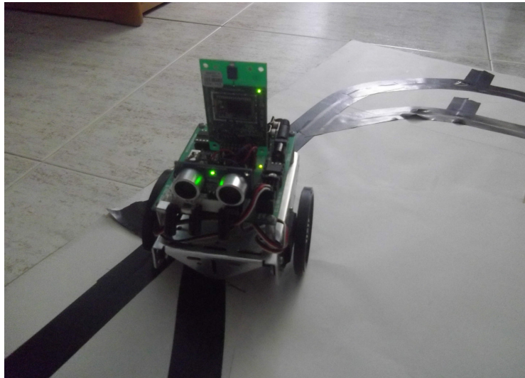
Figura 5.3. AGV Realitzant una bifurcació (Test Case 4)
