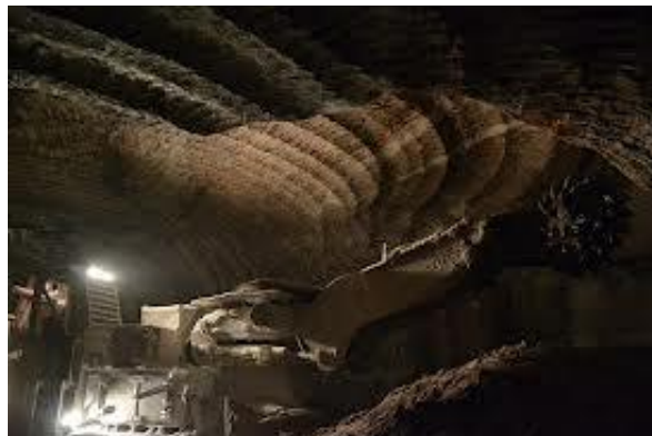
Figura 2.7. Minador a les mines de Cabanasses (Súria) on s'observa com el raspall a la part dreta de la fotografia arrenca el material de la paret de pedra.
